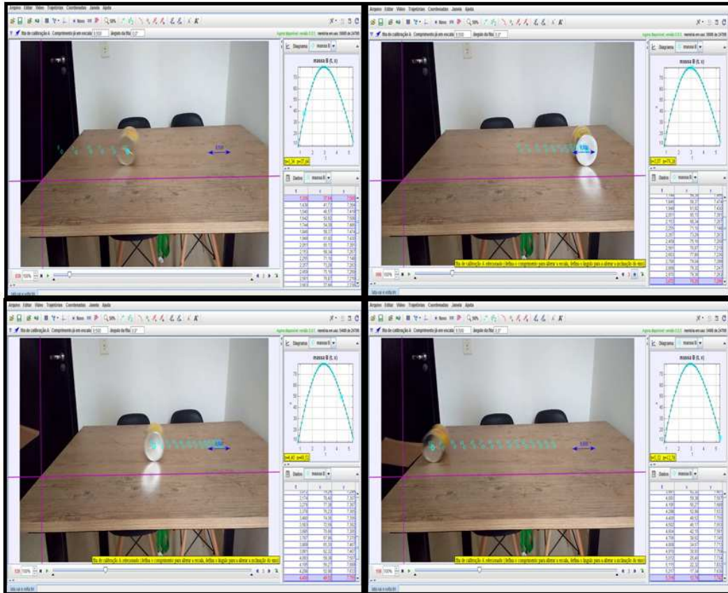
Figura 3.8 Imagens da tela do software Tracker durante a videoanálise do movimento da lata que vai e volta.
