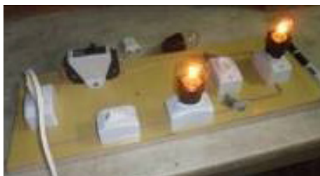
Figura 3 – Circuito elétrico (duas lâmpadas).
