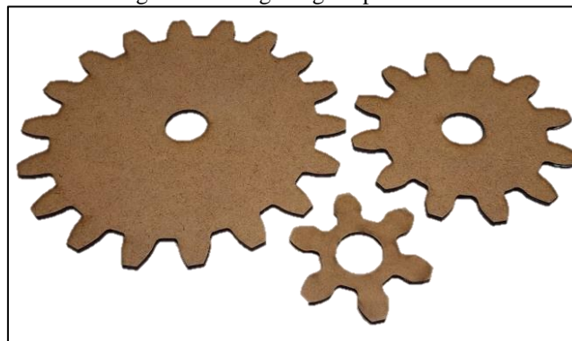
Figura 10 – Engrenagens produzidas em MDF
