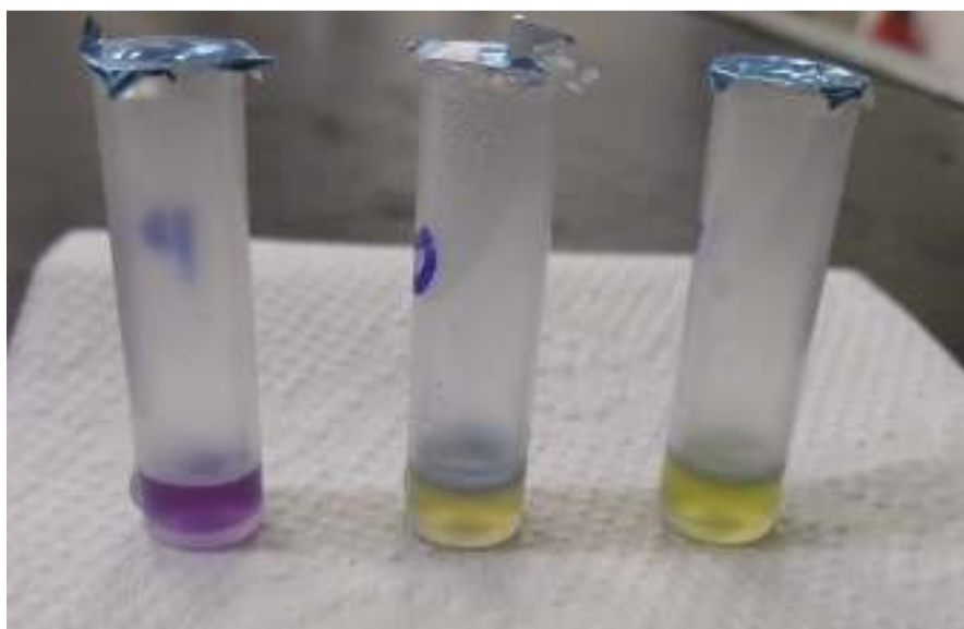
Figura 24: Resultados negativos do DelvoTest para duas amostras de leite de cabra cru comparativamente ao controle negativo (à esquerda). O controle negativo se mantém na coloração original (roxa), enquanto nos tubos inoculados foi observada ausência de resíduos inibitórios, permitindo que o esporo germinasse e fermentasse o açúcar do meio, alterando seu pH e ocasionando a viragem do indicador para amarelo.
