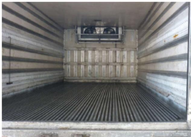
Figura 10. Caminhão refrigerado utilizado para o transporte de hortaliças minimamente processadas.
