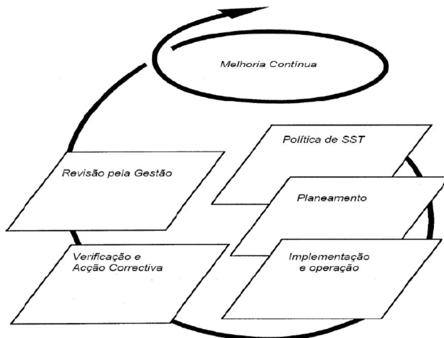
Figura 5: Modelo de Sistema de Gestão de Saúde e Segurança do Trabalho baseado no método PDCA ( Plan-Do-Check-Act / planejar-executar-verificar-agir). Fonte: OHSAS 18.001:2007.
