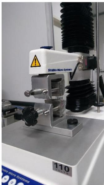
**Figura 7 -** Analisador de textura Texture Analyzer TA XT Plus (Surrey, Inglaterra) equipado para ensaios de tração.
