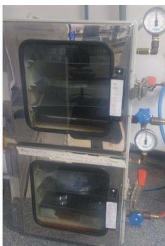
**Figura 5** - Câmara hermética a vácuo (Marconi, São Paulo, Brasil) usadas no condicionamento dos filmes.
