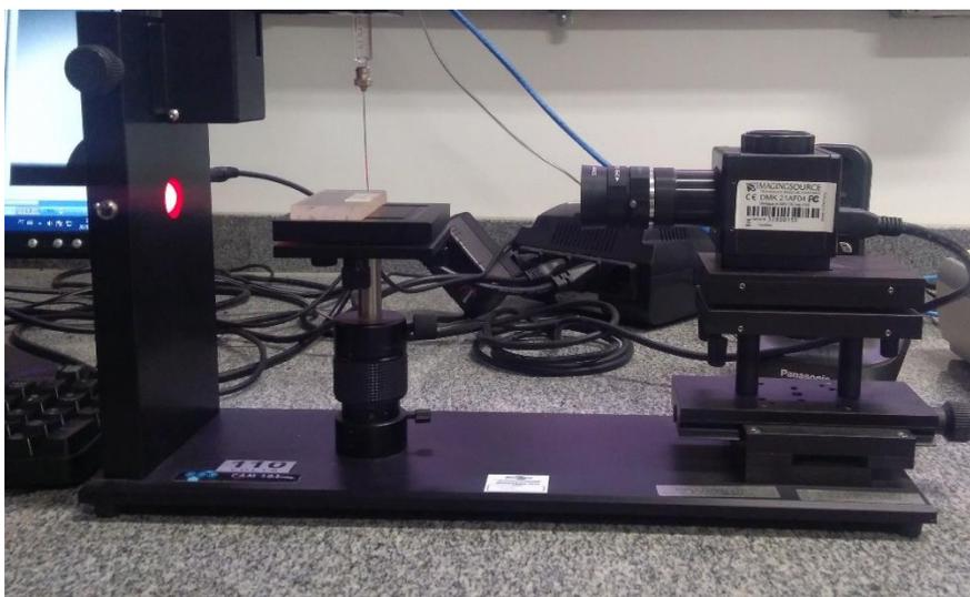
**Figura 8** - Medidor de ângulo de contato CAM 101(KSV, Cidade, Finlândia)
