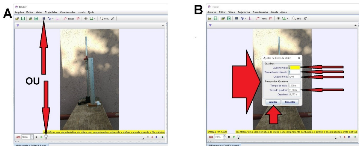
Figura 113 – Ajustes de passo, taxa de quadros e quadros inicial e final do vídeo no Tracker .
