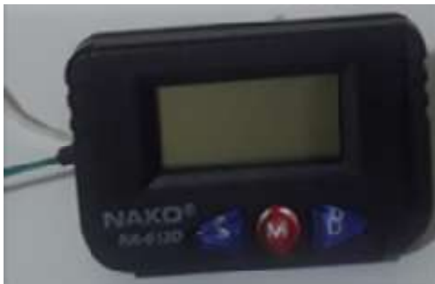
Figura 4.9 Relógio digital utilizado como carga a ser acionada pela célula solar. Fonte: próprio autor.
