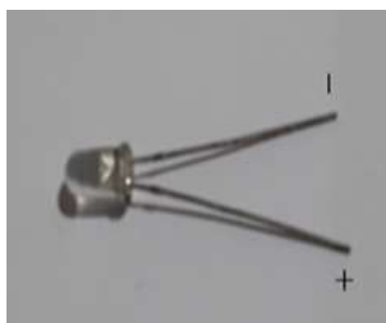
Figura 4.2 LED de alta eficiência que emite luz na cor vermelha.
