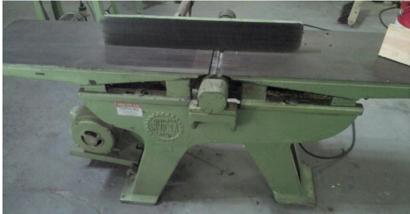
Figura 17 Equipamento utilizado para regularizar faces das peças de madeira
