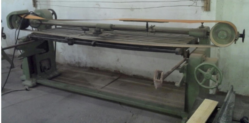
Figura 15 Equipamento utilizado para lixamento das peças de madeira.
