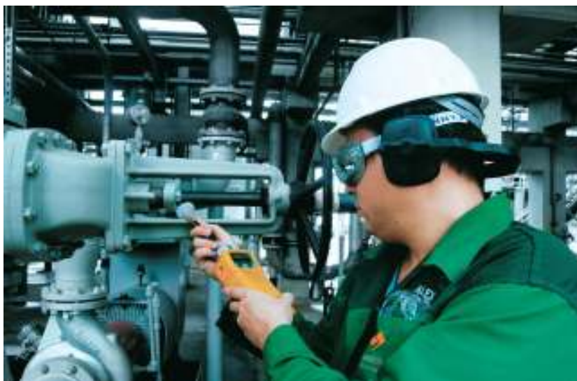
Figura 3.13 Monitoramento de campo com MiniRAE 3000 – Detector de vapores orgânicos (OVA - Organic Vapour Analyzer )
